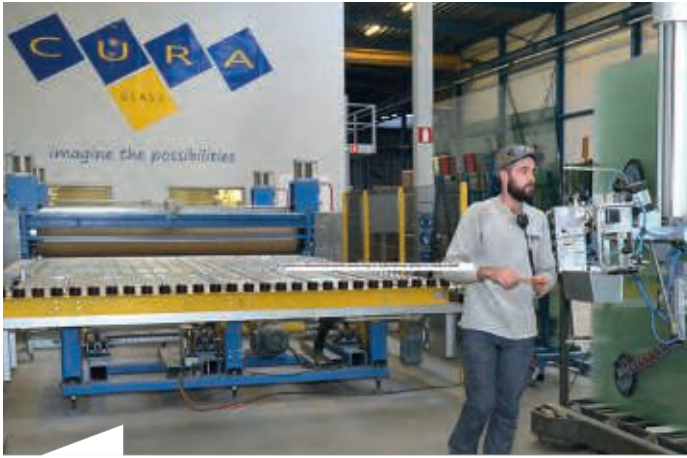
Am Einlauf der vollautomatischen Benteler Laminieranlage: Rund 30 Folienarten befinden sich bei Cura Glass ständig im Zugriff.
