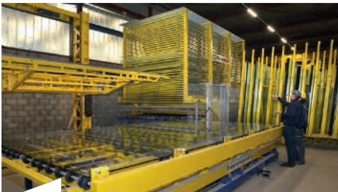
Vollautomatische Hegla-VSG-Zuschnittanlage mit Kompaktlager und VSG-Remaster.
