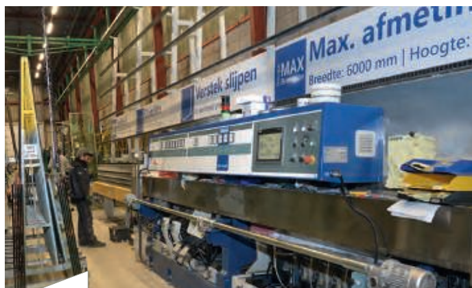
Die Kantenbearbeitung erfolgt in Höchstgeschwindigkeit mit einer Schleiflinie von Bovone. Dabei lassen sich Gläser von der Kleinscheibe bis zum Bandmaß bearbeiten.
