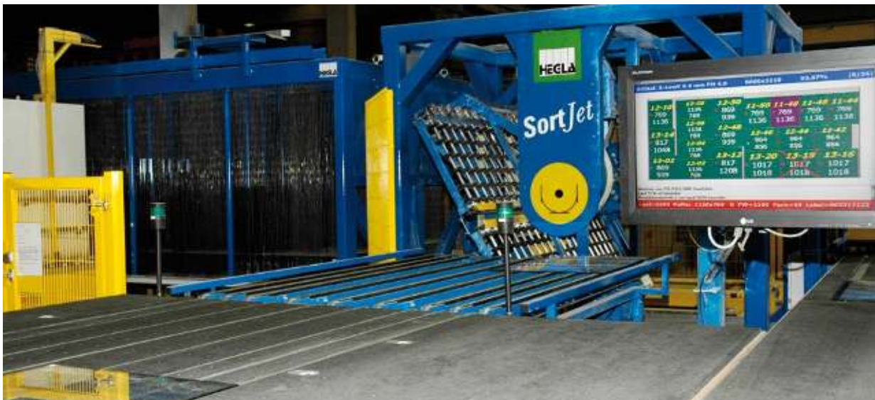
Oben: Ist die aber klein! Auch extrem kleine Zuschnitte durchlaufen reibungslos das Sortiersystem – besonders wichtig für SCHOLLGLAS TECHNIK, wo derartige Zuschnitte häufig anfallen. Selbstverständlich werden Großscheiben genau so zuverlässig befördert.
