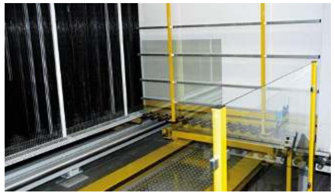
Das Output-Shuttle übergibt die Zuschnitte aus dem Puffer in Produktionsreihenfolge direkt an die Isolierglaslinie. Zustellscheiben wurden bereits vor dem Puffereinlauf zugestellt.
