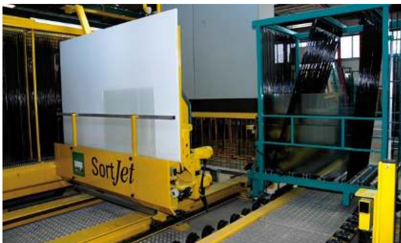
Das Output-Shuttle des SortJet hat eine Scheibe aus dem Puffer entnommen, fährt nun die von DynOpt errechnete Position auf dem Fächerwagen an und transportiert die Scheibe zuverlässig und ohne Gefahr von Beschädigungen, die ja bei manueller Befüllung von Fächerwagen nicht selten auftreten, in das ermittelte Fach ein. Dieser Vorgang erfolgt zügig und ermöglicht hervorragende Taktraten.
