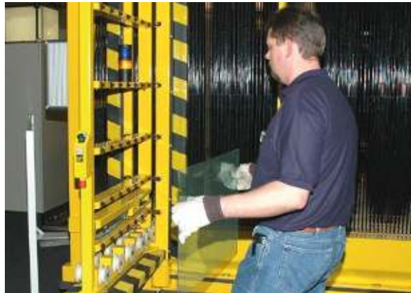
Manuelle Beladung mit der automatisch verfahrenen Beladehilfe, die CNC-gesteuert vor das errechnete Fach des SortJet fährt und die Scheibe aufnimmt.
