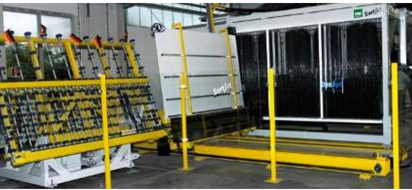
Der SortJet wird durch einen Kippförderer (links) direkt mit der vorhandenen Schneidlinie verbunden. Damit werden die geschnittenen Scheiben aufgerichtet und mit dem Beladeshuttle (Mitte) in das von DynOpt vorberechnete Fach des Sortierspeichers (rechte Bildhälfte) gefördert.
