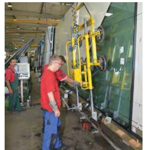
HoffmannGlas fertigt, liefert und montiert auch großformatige Sonderscheiben fachgerecht und zuverlässig – bis hin zum Jumbo-Maß.
