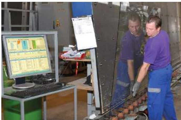
Der A+W Production-Monitor im Einlauf der ISO-Linie informiert über Scheibenaufbau, Schichtlage und Referenzkante.
