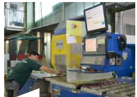
Hier steuert der CAM-DXF ein Bohr-/Fräszentrum, wodurch sich auch Losgröße 1 wirtschaftlich fertigen lässt.
