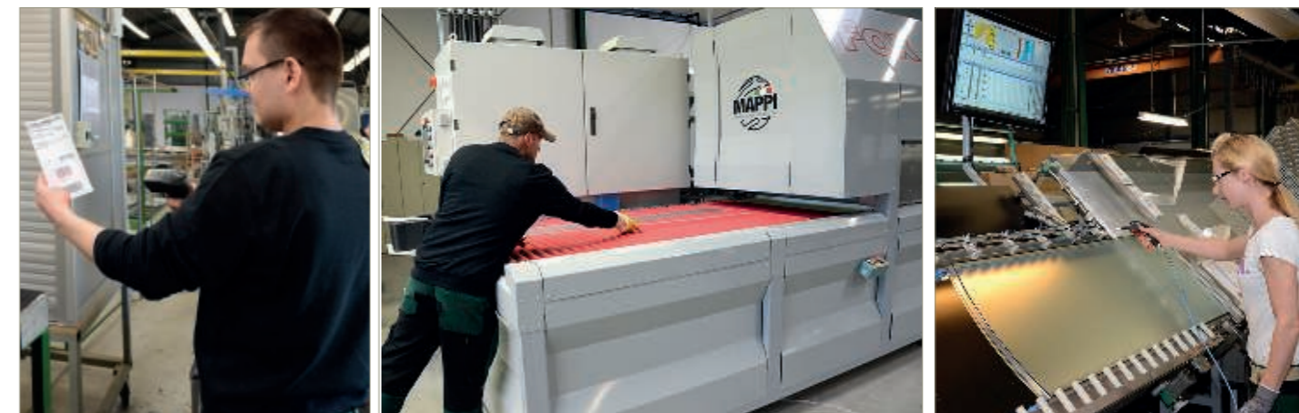
Links: BDE per Barcode-Lesung statt Produktionspapieren. Das Barcode-Etikett wird zum wichtigsten Informationsträger. Mitte: Der neue ESG Ofen, spezialisiert auf das hochwertige Vorspannen auch sehr kleiner Scheiben. Rechts: Spezial-Isolierglaslinie mit A+W Produktionsbildschirm, der sämtliche Scheibendaten übersichtlich dargestellt. Das erleichtert schnelles und sicheres Arbeiten, Fehler werden vermieden.
