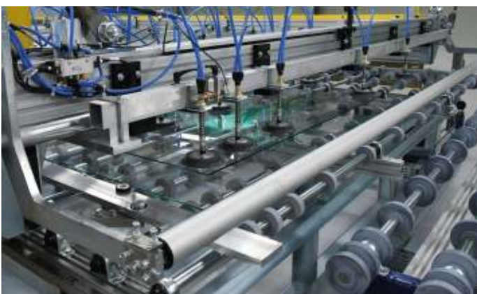
Vollautomatische VSG-Fertigung mit der neuen Benteler-Anlage
