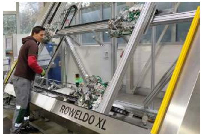
Links: Spezial-Isolierglaslinie zur Fertigung hochwertiger Haustürfüllungen mit bis zu 4-fach-Isolierglas Oben: Rahmenschweißautomat für Swisspacer-Profile
