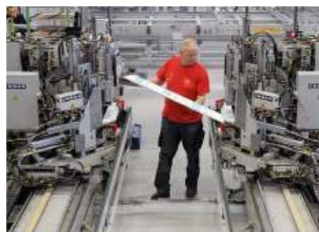
Der Werker am Schweißautomaten bekommt via A+W Cantor CIM angezeigt, welche Profile er einlegen muss
