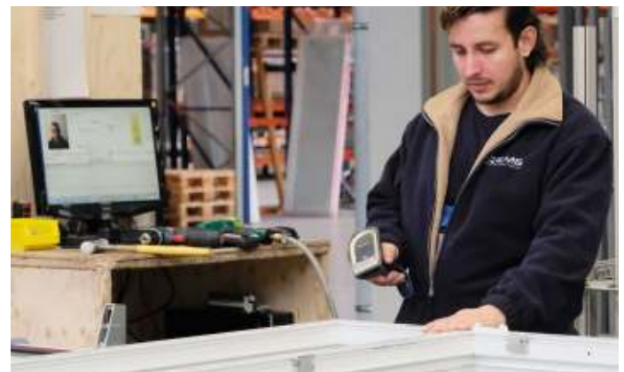
Arbeitsplatz mit A+W Cantor CIM: Monitore und Scanner ersetzen Produktionspapiere und Laufmappen
