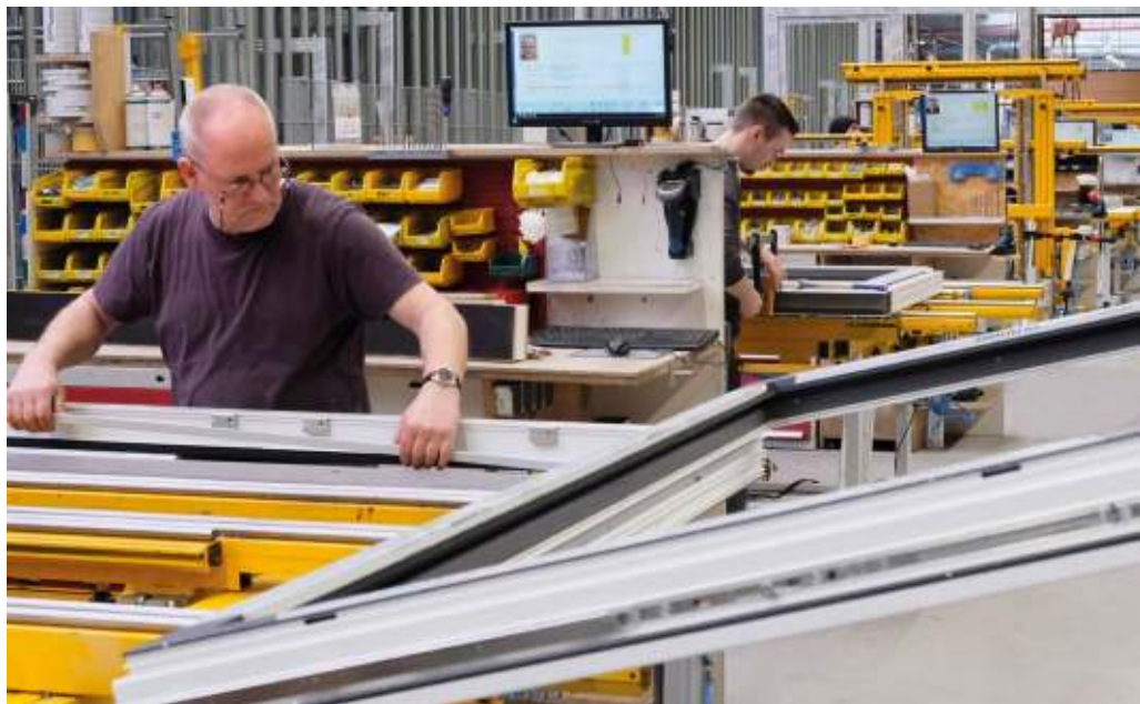
Sonderbau-Arbeitsplätze mit automatischer Zuführung der Elemente
