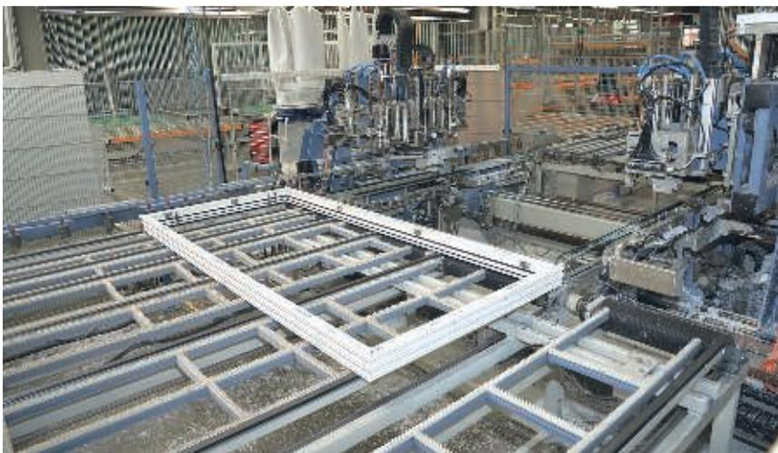
Über Transportstrecken und über Software gesteuerte Shuttles werden die Rahmen und Flügel zwischen den Bearbeitungsstationen weiterbefördert und in Puffer verbracht.
